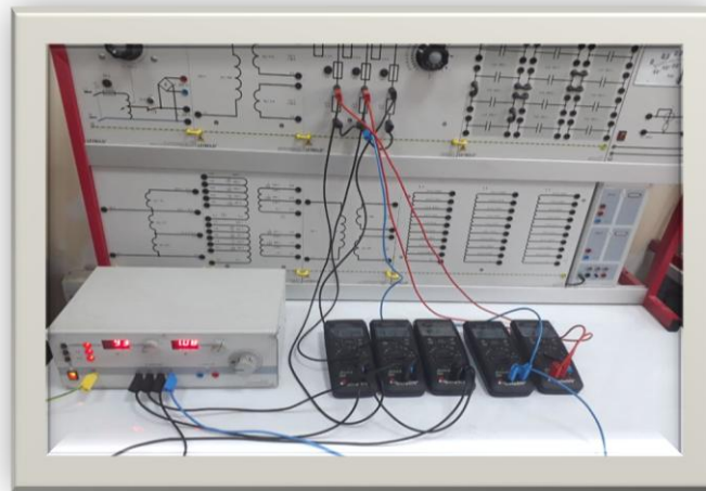
Схема 3. Схема звездообразного соединения трехфазных электрических цепей через простые резисторы.
